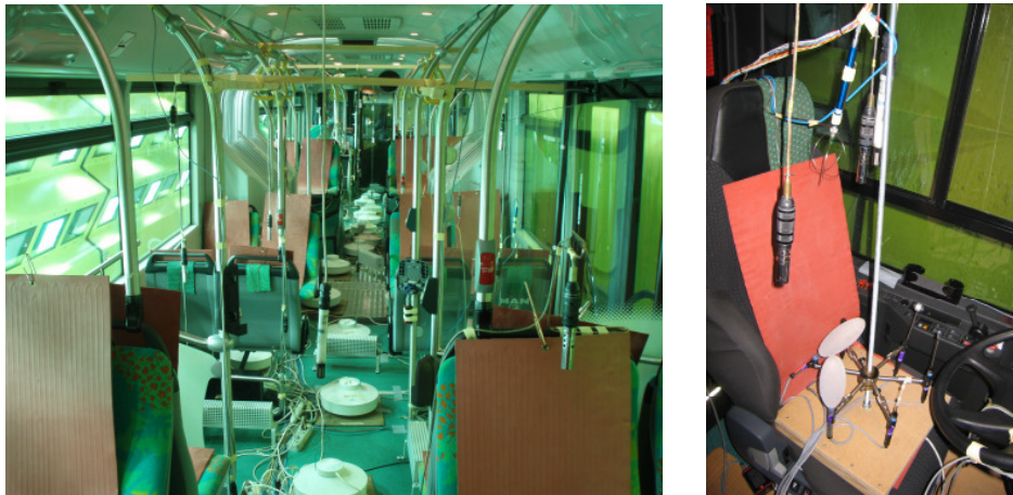
Abb. 3: Messung der Behaglichkeit im Fahrgastraum und Fahrerkabine
