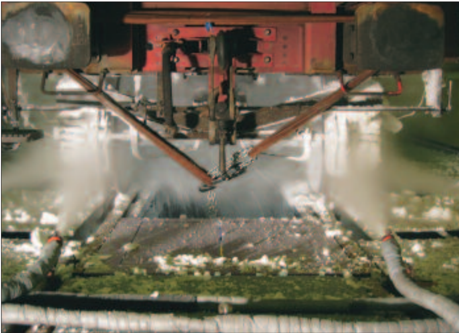
Bild 7: Bremstests an Alu-Klotzbremsen unter Schneebedingungen am Rollenprüfstand
