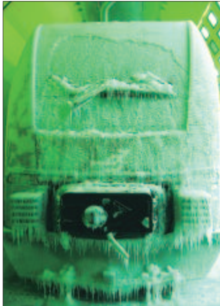
Bild 4: Ausgangszustand für Funktionstests unter schwedischen Winterbedingungen am ITINO für TiB
