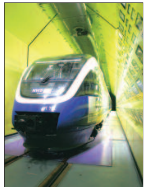
Bild 3: D-Talent von Bombardier für die NordWestBahn im Klimatest
