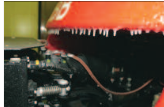
Bild 6: Die Kupplung am „E-Talent“ ist mit einer 3 Millimeter dicken Eisschicht überzogen
