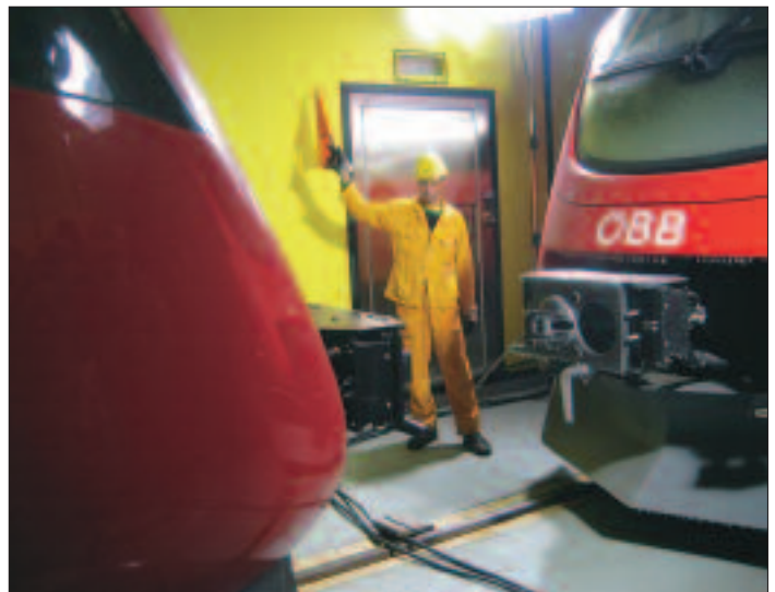
Bild 6: Die Kupplung am „E-Talent“ ist mit einer 3 Millimeter dicken Eisschicht überzogen
