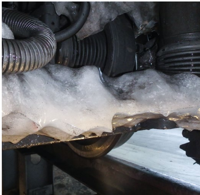
Abb. 6: Schnee- und Eisansammlung im Drehgestellbereich im realen Betrieb Quelle: RTA
