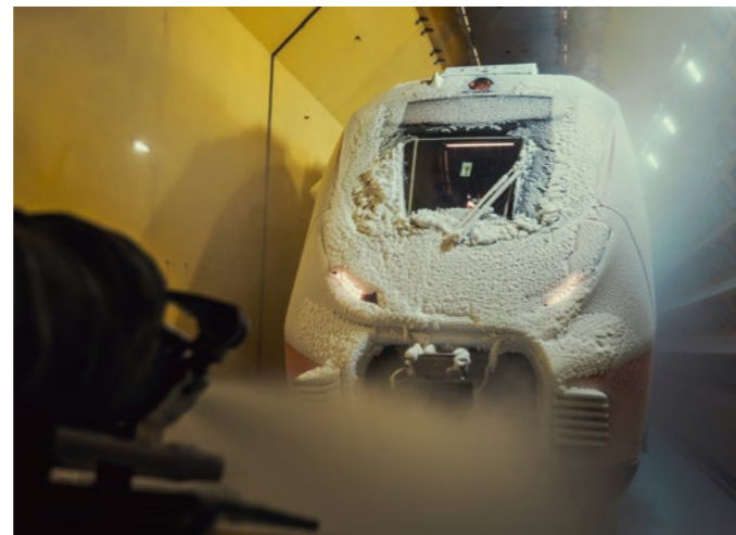
Abb. 2: Scheibenwischertests mit Nassschnee
