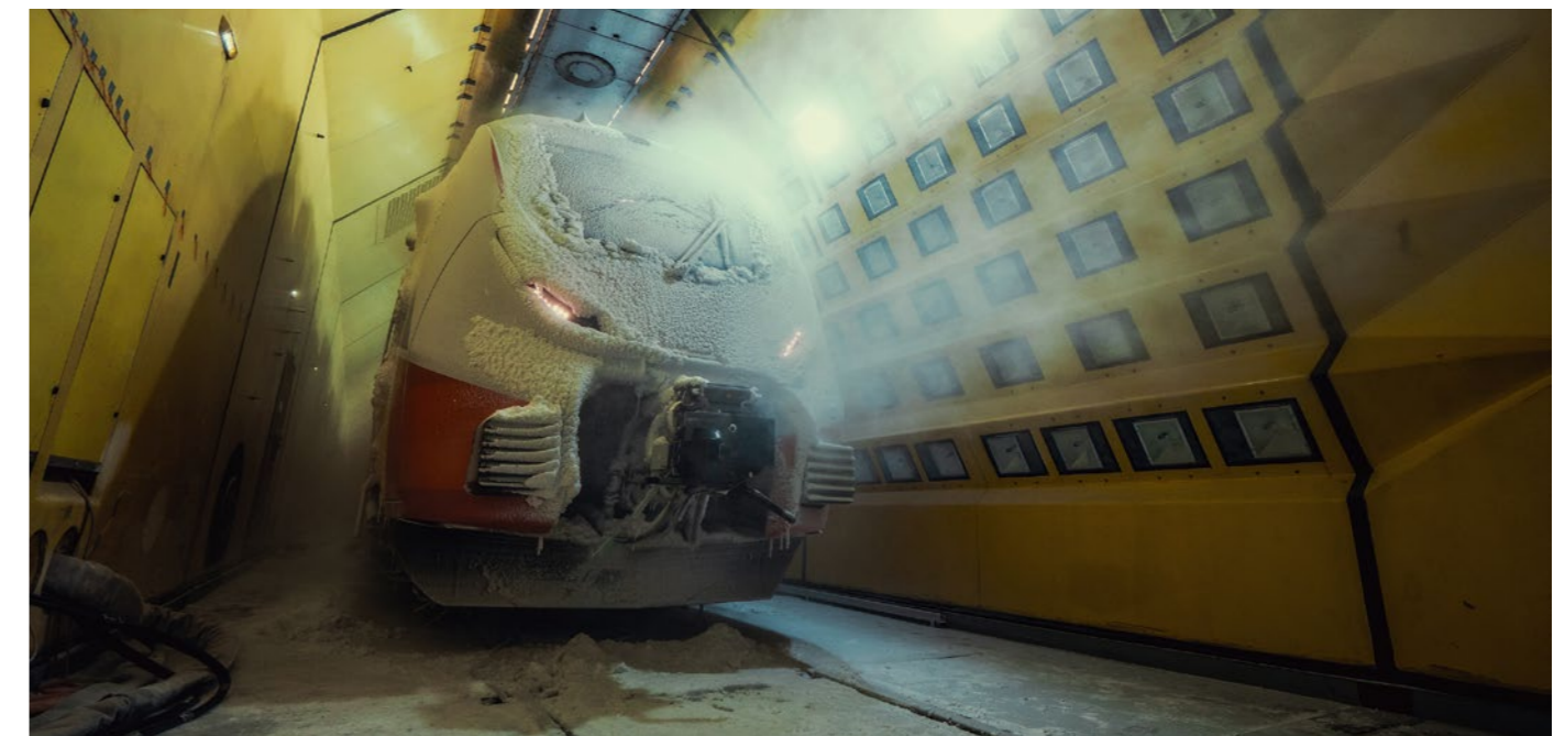
Abb. 1: Realistische Fahrbetriebsbedingungen mit Schnee im Klima-Wind-Kanal Quelle: Bombardier
