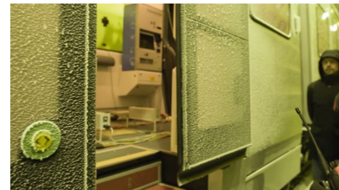
Abb. 3: Seitentüre mit trockenem Flugschnee
