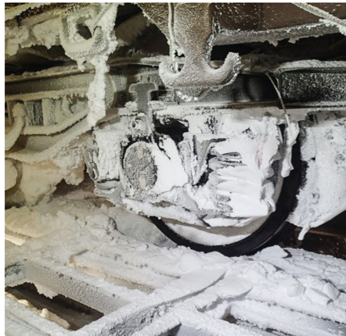
Abb. 7: Schnee- und Eisansammlung an einem Drehgestell am Rollenprüfstand Quelle: RTA
